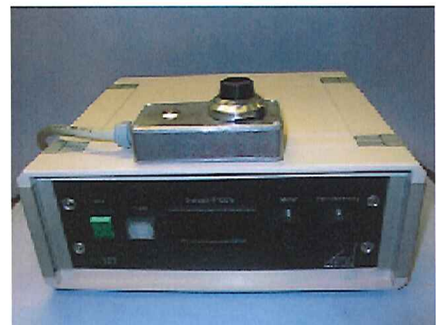
15E溶射ガン用エレクトリックドライブコントローラー Electric Drive Controller for Flame Spray Gun 15E
